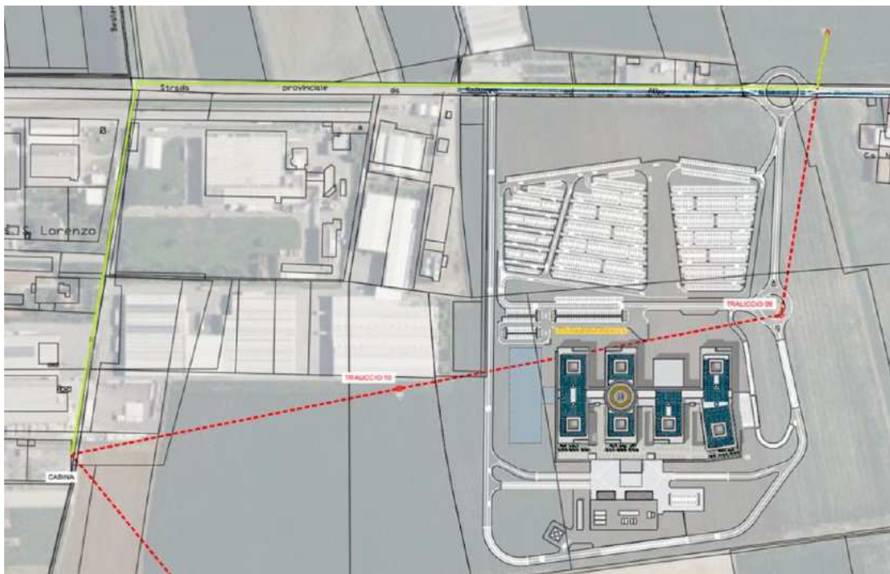
Figura 4: soluzione alternativa n. 1 (in giallo) per eliminare l'interferenza della linea AT con l'ospedale.
